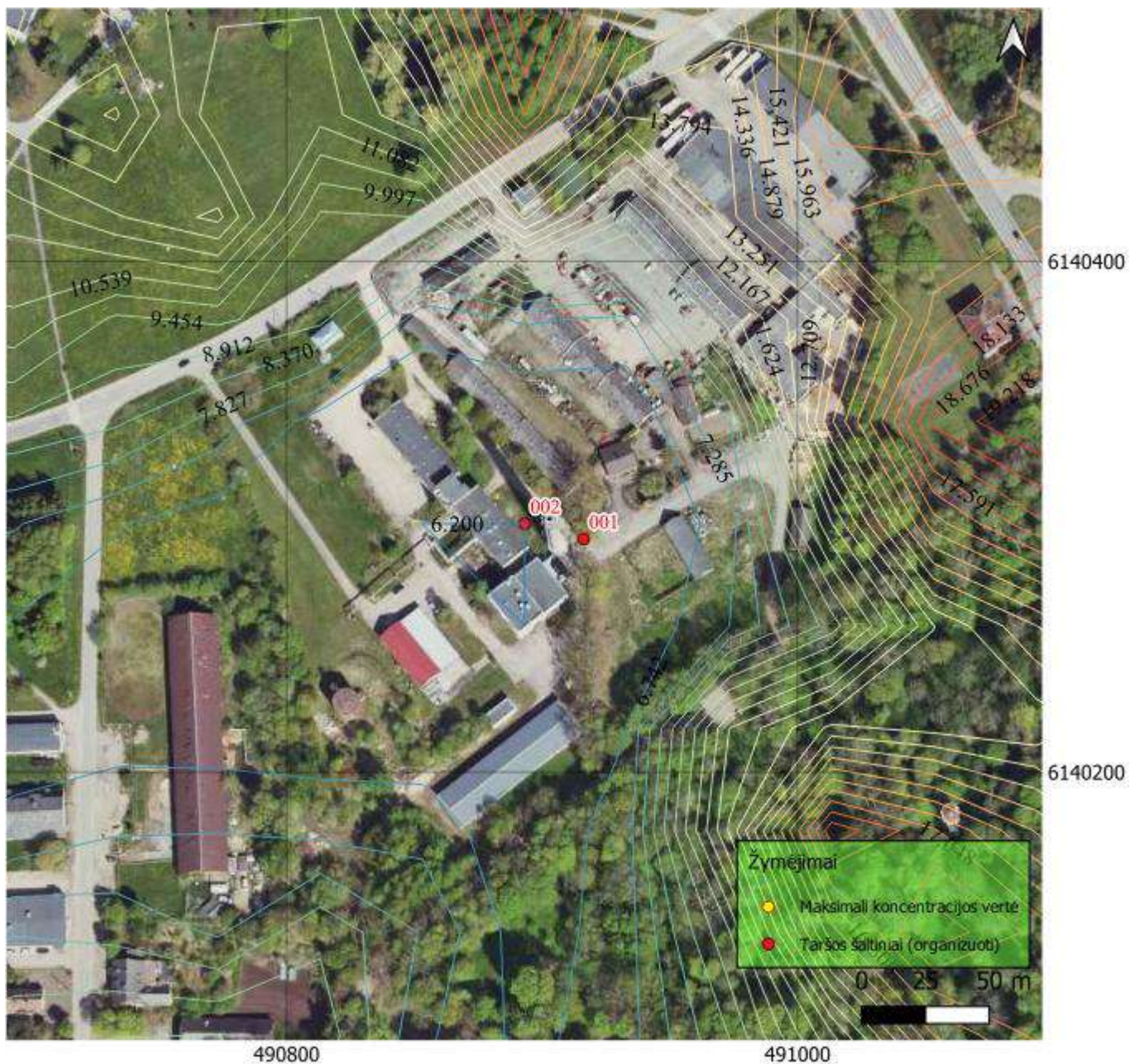
16 pav. Sumodeliuotų NO 2 pažemio koncentracijų sklaidos žemėlapis (400 m x400 m ribose). Azoto dioksido 1 valandos 99,8-o procentilio koncentracijų izolinijos (µg/m 3 ).
