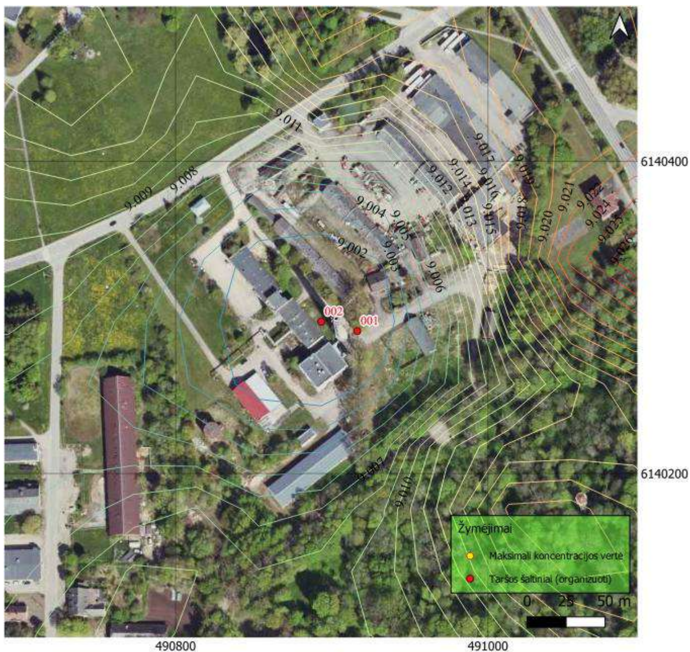
20 pav. Sumodeliuotų KD_{10} pažemio koncentracijų sklaidos žemėlapis (400 m x400 m ribose). Kietųjų dalelių KD_{10} 24 valandų metų vidutinių koncentracijų izolinijos ( \mu\text{g}/\text{m}^3 ).
