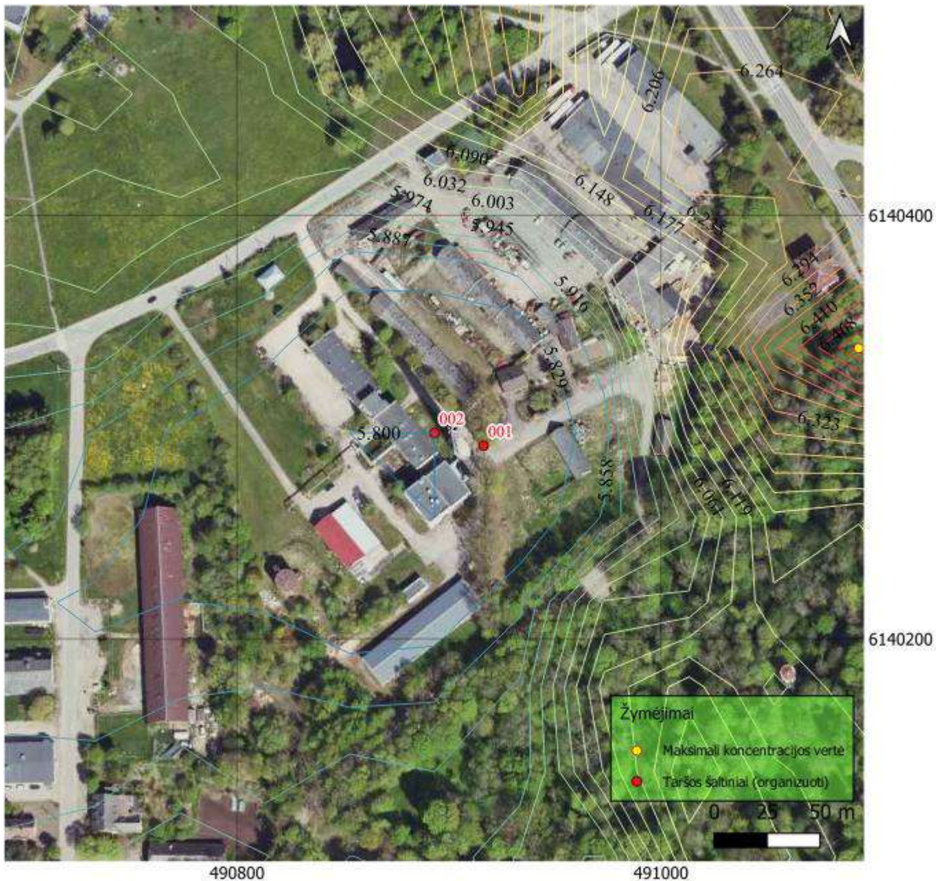
24 pav. Sumodeliuotų KD_{2,5} pažemio koncentracijų sklaidos žemėlapis (400 m x400 m ribose). Kietųjų dalelių KD_{2,5} 24 valandų 99,18-o procentilio koncentracijų izolinijos ( \mu\text{g}/\text{m}^3 ).
