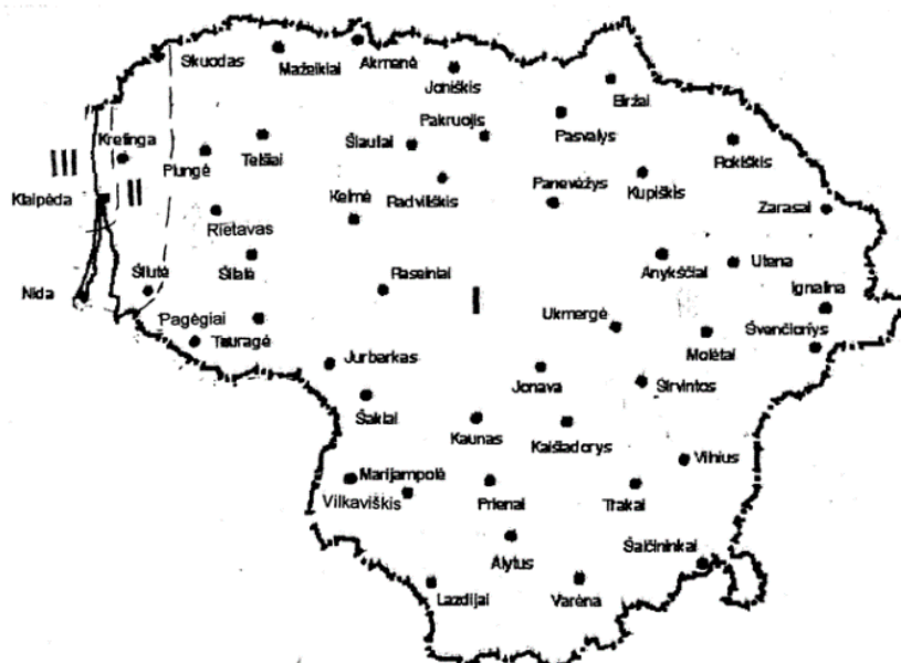
Pav. 1. Lietuvos vėjo apkrovos rajonai I – v_{ref,0} = 24 \text{ m/s} , II – v_{ref,0} = 28 \text{ m/s} , III – v_{ref,0} = 32 \text{ m/s}
