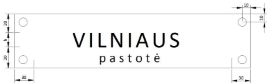
1 pav. 110-330 kV transformatorių pastočių pavadinimo lentelė
